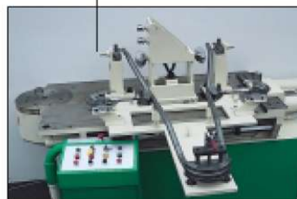
Réalisation simultanée de 4 cintres sur un châssis de brouette
